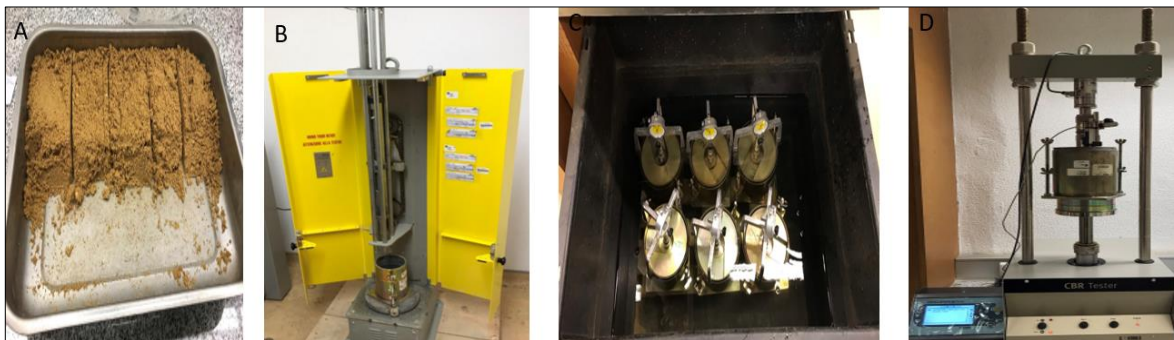
Figura 18 - Realização do ensaio CBR: separação dos provetes em camadas (A); compactador automático (B); ensaio CBR na fase de expansão do material em molde grande com defletómetro (C); estrutura de compressão CBR (D)
