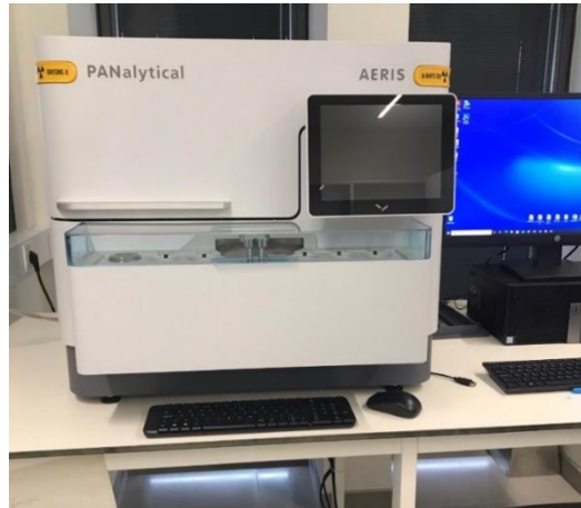
Figura 20 - Difrátometro de Raios-X utilizado para identificação mineralógica por difração dos Raios X.
