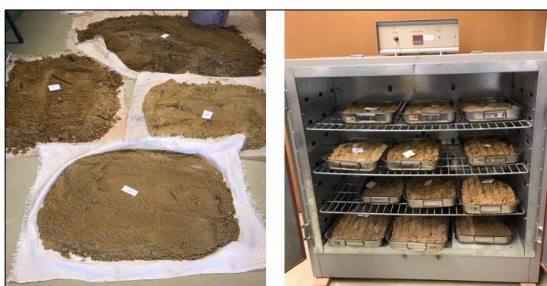
Figura 14 - Amostras no processo de secagem ao ar (A); secagem da amostra em estufa (B)
