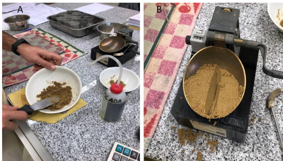
Figura 3 - Ensaio de Limite de Liquidez com o equipamento da concha de Casagrande (B). Mistura do material com água destilada (A); após divisão do provete na perpendicular ao eixo da manivela formando um sulco através de um riscador.
