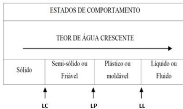
Figura 2 - Representação esquemática do significado físico dos limites de consistência: LC – Limite de Contração; LP – Limite de Plasticidade; LL – Limite de Liquidez (adaptado de Caputo, 1996).
