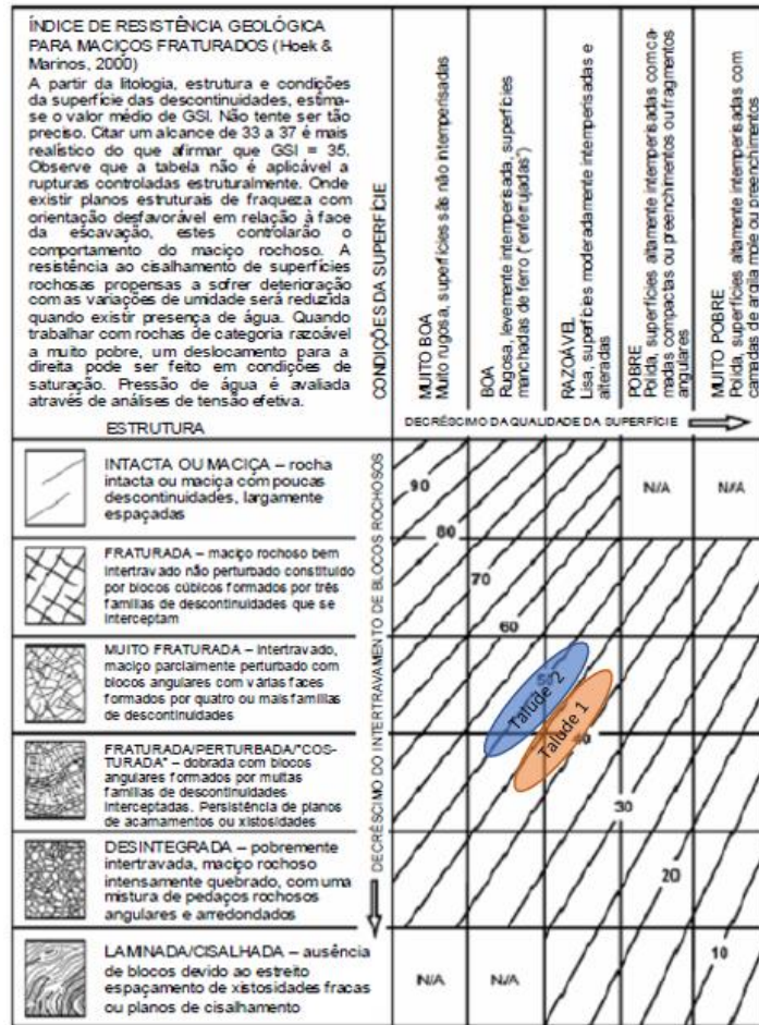
Figura 38 – Estimativa dos valores de GSI dos Taludes 1 e 2 a partir da observação de campo (representação gráfica do GSI de Marino et al. , 2005 in Damasceno, 2008).
