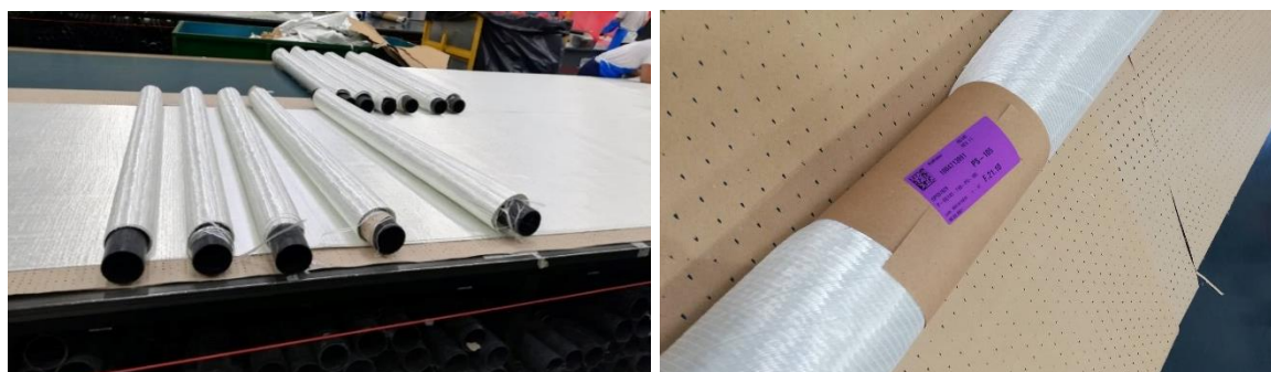
Figura 11 - Enrolamento de fibra (esquerda) e embalagem das peças (direita)
