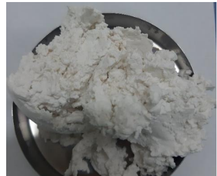
Figura 4.28. Reticulação total do látex com 24 ml de solução de ácido.
