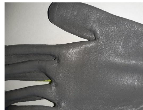
Figura 3.5. Revestimento espesso resultado de um pH acima do especificado.
