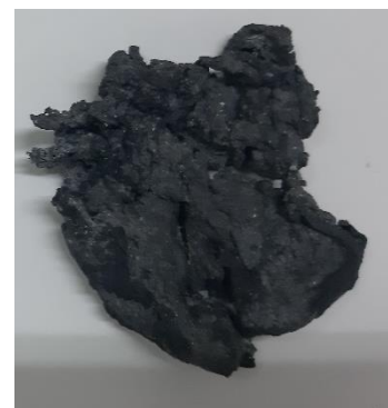
Figura 4.24. Reticulado formado recorrendo ao excesso da solução de ácido (escala laboratorial)
