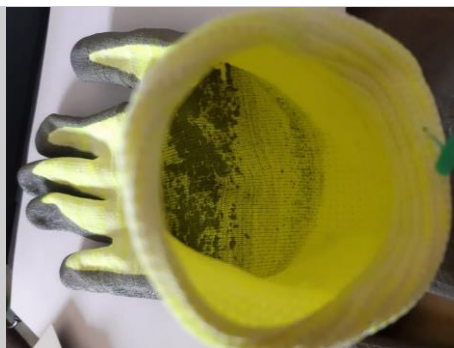
Figura 3.6. Passagem do revestimento para o interior do liner (penetração) resultado de uma TS abaixo do especificado.
