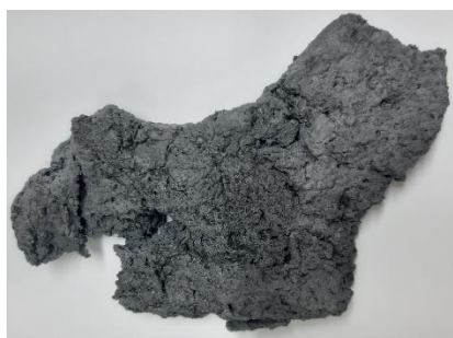
Figura 4.22. Reticulado formado aquando do armazenamento da formulação NITPUG (escala industrial)
