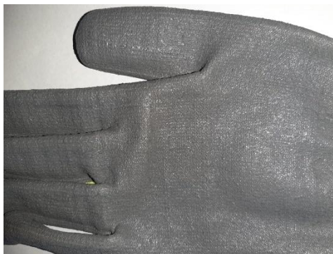
Figura 3.4. Revestimento fino resultado de um pH abaixo do especificado.
