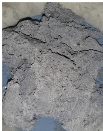
Figura 4.3. Reticulado formado à superfície da amostra no contentor de armazenamento ( t = 0 semanas).
