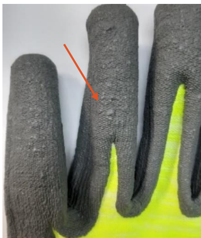
Figura 4.8. Luvas defeituosas produzidas com o revestimento NITPUG II (com 20% do NITPUG armazenado uma semana e meia)
