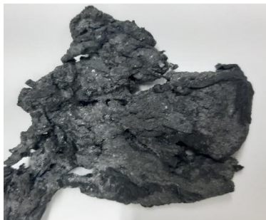
Figura 4.23. Reticulado formado recorrendo ao excesso de \text{NH}_4\text{OH} (escala laboratorial)
