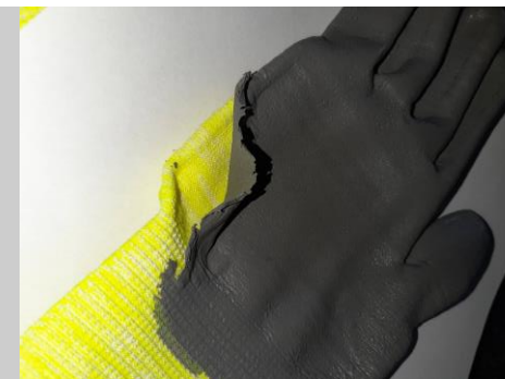
Figura 3.7. Falta de adesão do revestimento ao liner resultado de uma TS acima do especificado.
