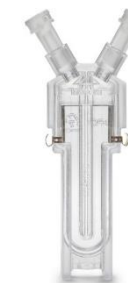
Figura 3.3. Célula DTS1070 para análise do potencial zeta.
