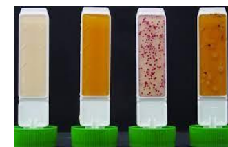
Figura 3.2. Teste Cult Dip Combi para deteção de bacterias e fungos; Amostra não contaminada (esquerda) e amostra contaminada (direita)
