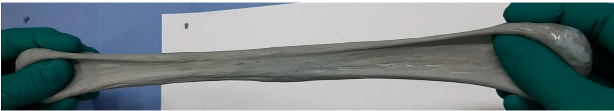
Figura 3.11. Resultado do teste empírico de clorofórmio para a suspensão química NITPUG_N.
