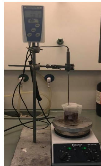
Figura 3.5. Instalação usada na síntese da lenhocelulose catiónica.
