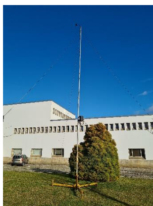
Figura 3.2 – Estação meteorológica fixa no DEM da Universidade de Coimbra.
