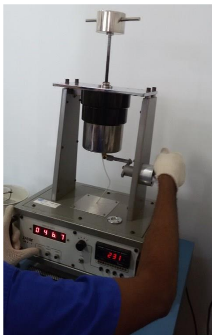
Figura 6 - Determinação do índice de fluidez de PRec.
