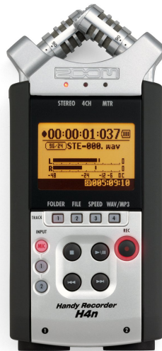
Figura 3.1: Microfone Zoom H4n Handy Recorder , usado na captação dos sinais acústicos da população da amostra [71].
