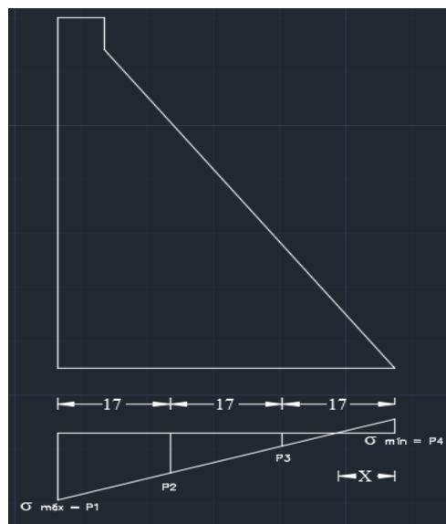
Figura 0.1 – Esquema com as tensões para cálculo na condição de construção final
