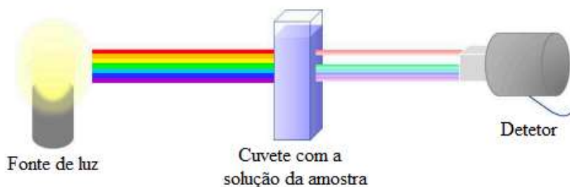
Figura 14 – Demonstração do funcionamento de um espectrofotómetro UV-Vis. Adaptado de https://bit.ly/38NTF5O .
