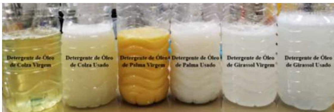
Figura 47 - Detergentes de óleo de colza, girassol e palma virgens e usados, preparados em laboratório.
