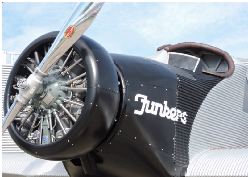
Figura 2.1.1 - Junkers F13 em 1919, o primeiro avião concebido para transporte aéreo, feito de metal.
