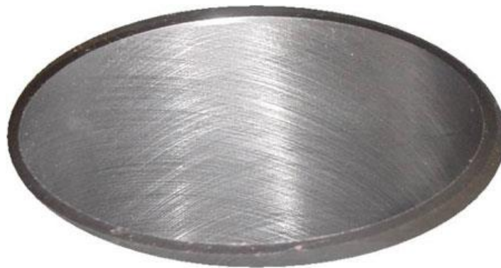
Figura 2.4 Superfície do interior de um cilindro após processo de honing, de [45]
