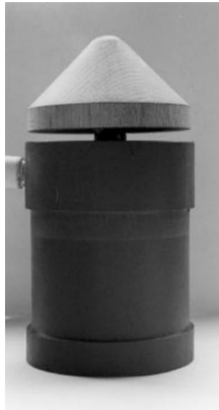
Figura 2.16. Célula de carga integrada no objeto de impacto (Warnet & Greasley, 2001).
