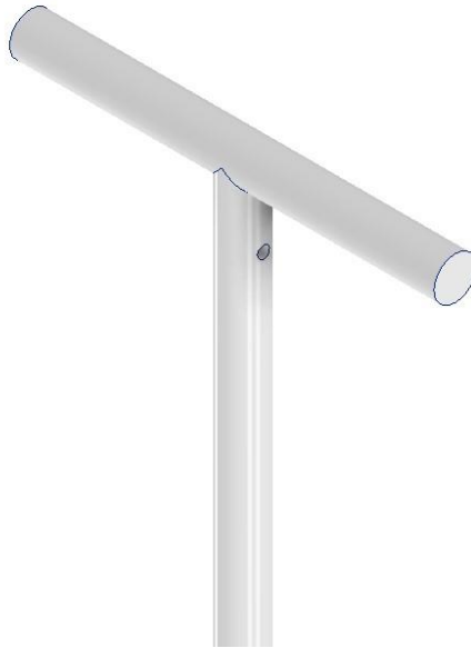
Figura 3.10. Extremidade superior do pêndulo com uma pequena furação para uma chave que permite um lançamento preciso no ângulo pretendido.
