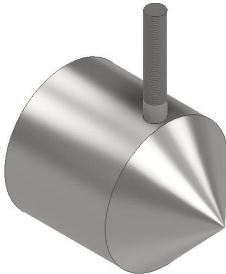
Figura 3.14. Aríete em aço inoxidável com ponta bicuda.
