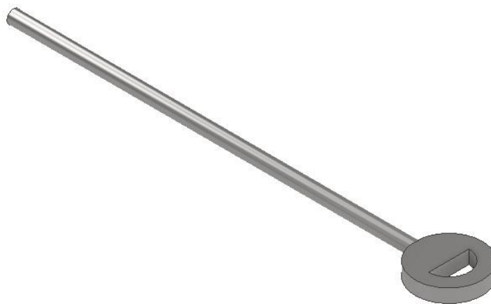
Figura 3.23. Chave que permite um lançamento exato do pêndulo.
