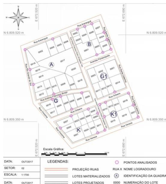
*Figura 19 - Planta cadastral obtida com o levantamento GNSS. Fonte: Lara et. al. (2017)*
