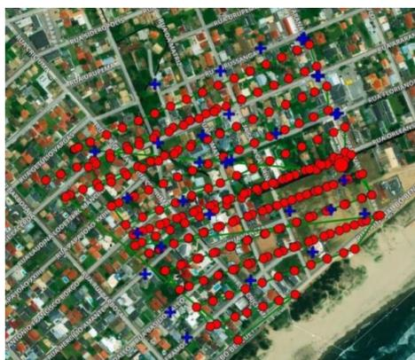
*Figura 18 - Resultado obtido ao serem importados os dados adquiridos no software Pix4D. Fonte: Lara et. al. (2017)*
