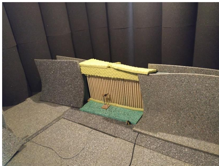
Figura 4.9 – Adição de placas de espuma nas partes laterais da amostra.
