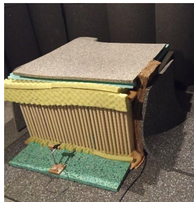
Figura 4.11 – Amostra com configuração tipo “Túnel”.
