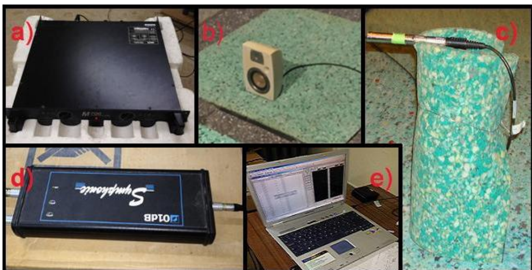
Figura 4.1 – Equipamentos utilizados nas medições: a) amplificador; b) fonte sonora; c) microfone; d) Symphonie; e) computador portátil com software dBati32 (adaptado de Dias, 2014).
