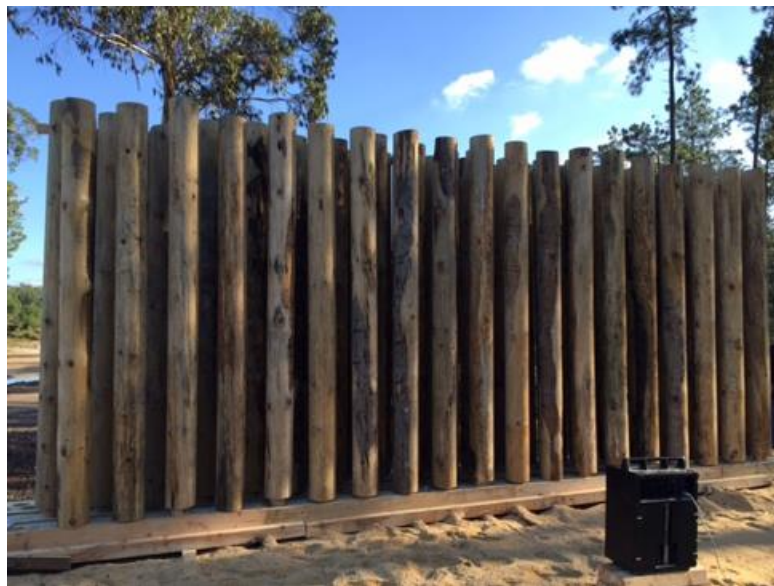
Figura 2.16 – Barreira acústica com cristais sônicos ensaiada por Amado Mendes et al. (adaptado de Amado Mendes et al. , 2016).
