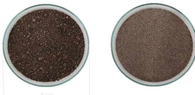
Figura 4.2 - (a) Cinzas de biomassa; (b) Cinzas de biomassa após crivagem (< 425 µm).
