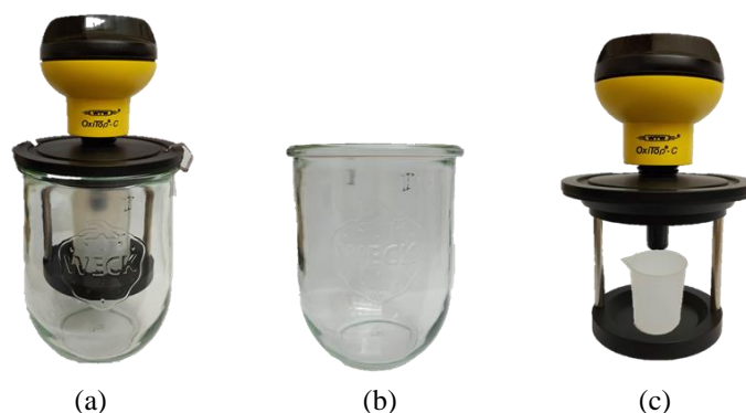
Figura 4.4 - Oxitop®: a) Oxitop® completo; b) vaso de 1 L onde é colocada a amostra; c) cabeça do aparelho, através da qual é medida a pressão e recipiente do absorvente de CO 2 .
