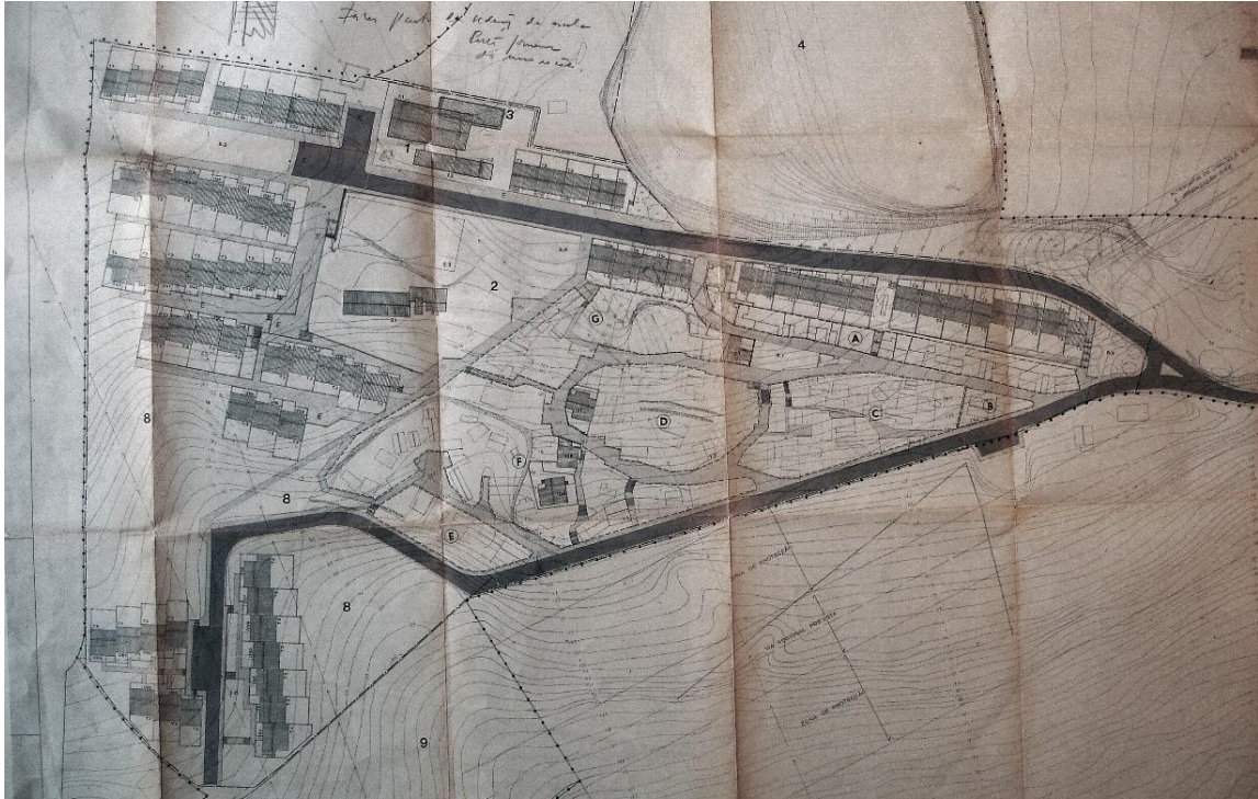
Fig. 11.12 – Planta, Plano Geral de Urbanização com a localização de novas habitações e já centro social (número 1, com sala polivalente, associação de moradores, cooperativa e posto médico), escola primária (2), creche (3), zona desportiva (4), áreas ajardinadas (6), comércio (7) e exploração agrícola (9), janeiro de 1979. Fonte: Arquivo Bartolomeu Costa Cabral
