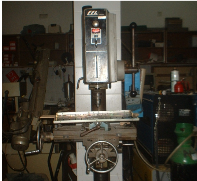
Figura 3.9 - Furação da placa de metal com uma furadora de coluna
