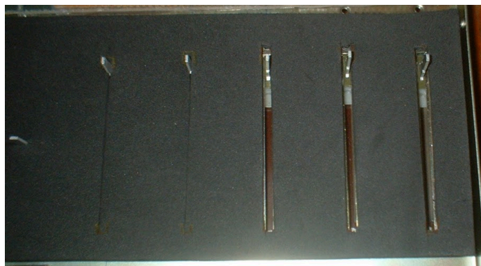
Figura 3.25 - Superfície de espuma preta para não reflectir a luz dos outros LEDs
