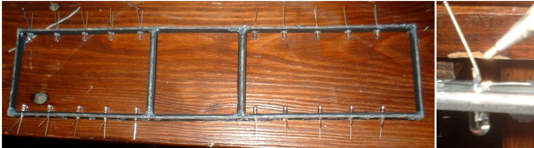
Figura 3.26 - Estrutura e soldadura dos fios aos LEDs dos mixers
