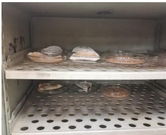
Figura. 5.8. – Amostras na estufa a 40°C.
