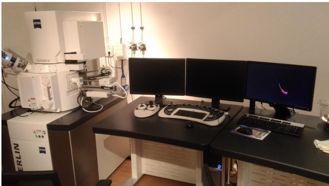
Figura 3.6. Equipamento SEM/EDS utilizado na avaliação da composição química e morfologia dos revestimentos produzidos.
