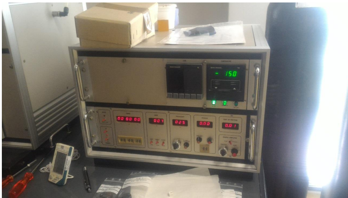
Figura 3.11. Equipamento de SRV utilizado para os testes de deslizamento alternativo.
