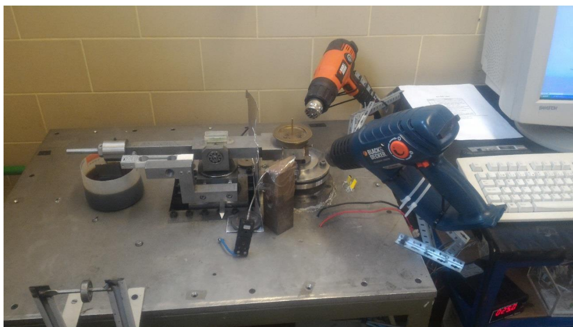
Figura 3.10. Equipamento de pino-disco utilizado.
