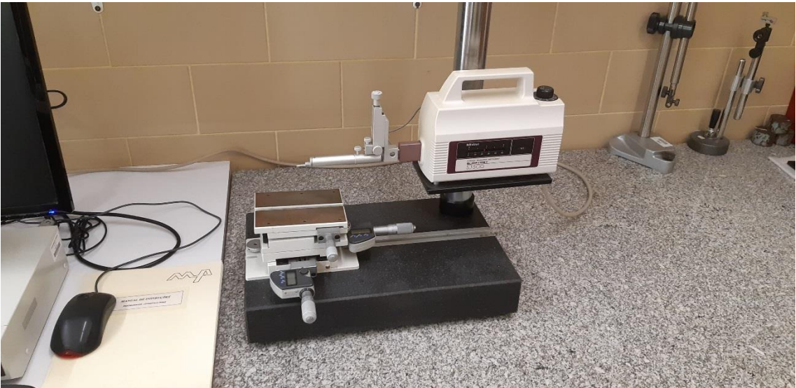
Figura 3.13. Perfilómetro 2D SURFTEST SJ-500.
