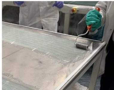
Figura 3.1. Impregnação manual do laminado.
