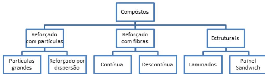
Figura 2.7. Classificação dos compósitos quanto ao tipo de reforço [10].
