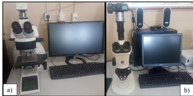
Figura 3.6. Aparelhos utilizados para visualizar as superfícies de fratura das amostras: a) Microscópio Ótico; b) Lupa.
