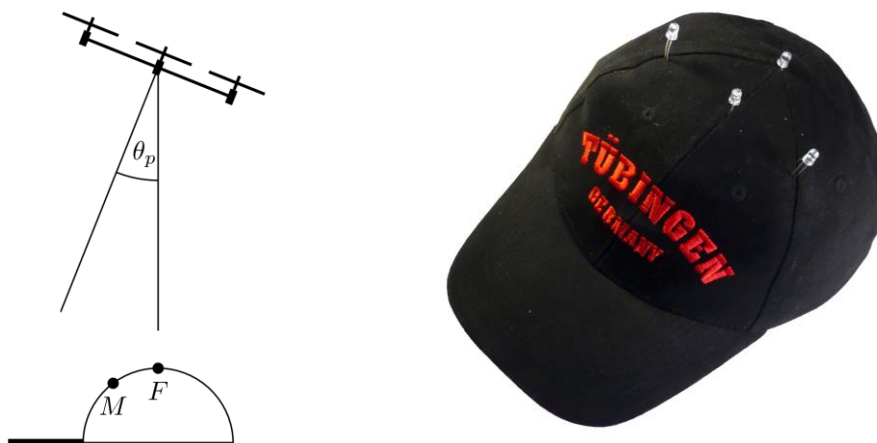
شکل ۲-۲۸ - کلاه به همراه LED مادون قرمز (تصویر راست) - نحوه قرارگیری پهپاد نسبت به شخص (تصویر چپ) [۳۰]
