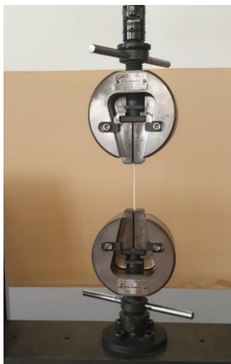
Figura 2.1. Equipamento de resistência à tração durante um ensaio.
