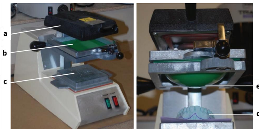
Figura 1.7. Equipamento de termoformação em vácuo: a) unidade de aquecimento; b) folha de material fixada no suporte; c) unidade de vácuo; d) molde da boca do atleta; e) aquecimento do material até à cedência da folha (adaptado de [22]).
