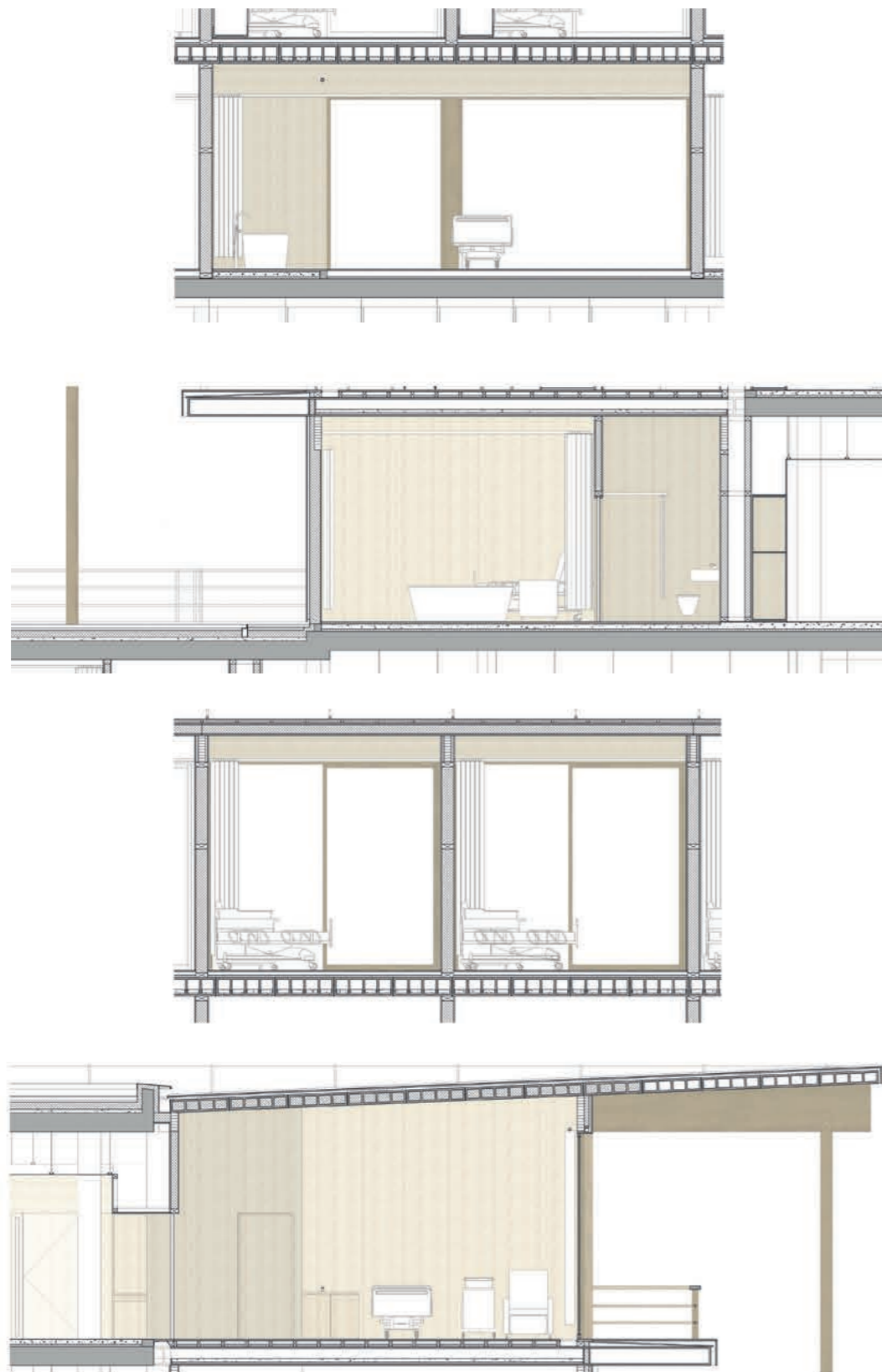
73. Cortes A A' e C C' da suíte de parto Cortes A A' e C C' do quarto de internamento (nota: legenda de materiais em desenho em anexo)
