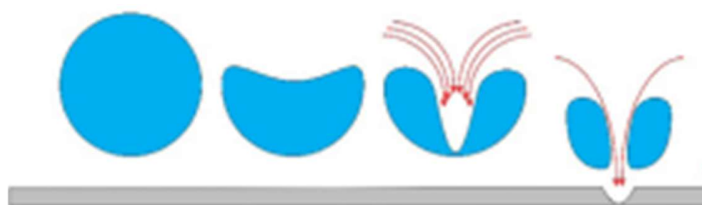
Figura 23. Representação do fenómeno de cavitação acústica. 174
