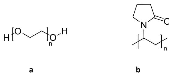
Figura 12. Estrutura molecular: (a) PEG; (b) PVP.
