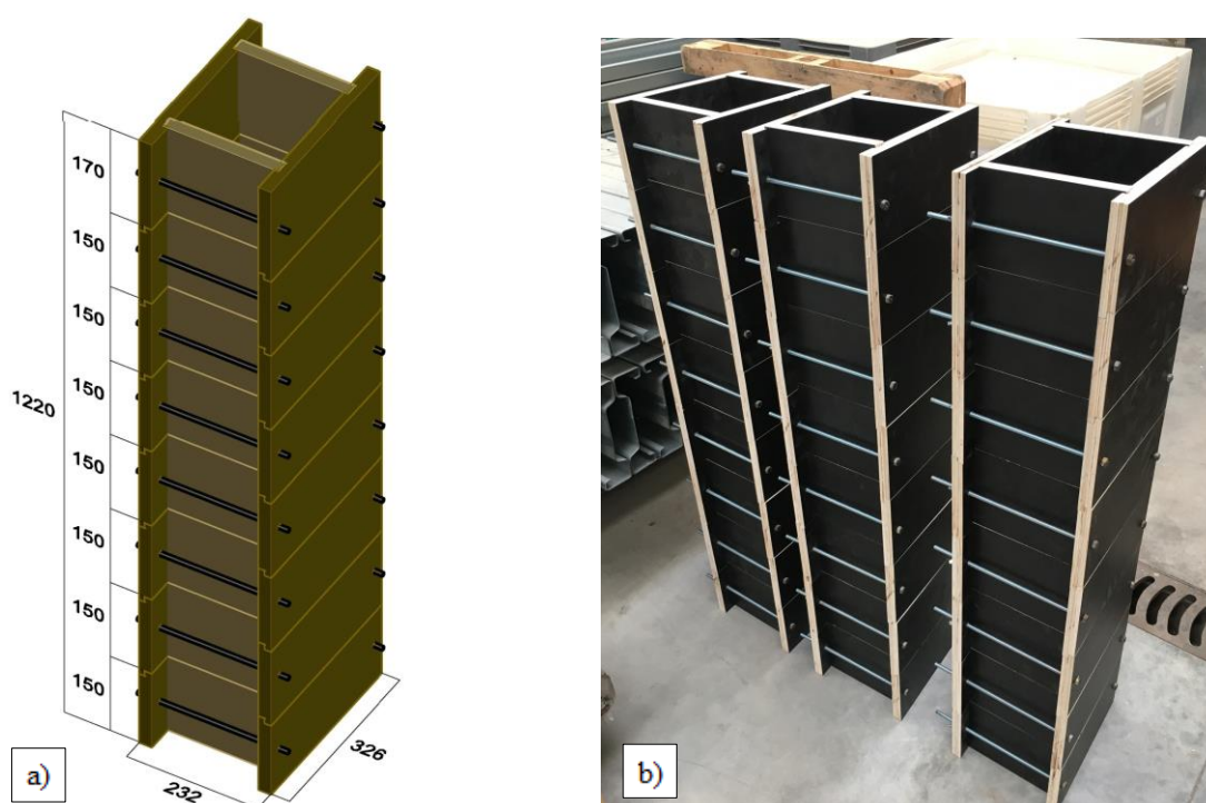
Figura 4.2 – Cofragem utilizada na betonagem dos provetes: a) Dimensões dos conjuntos das cofragens utilizadas (mm); b) Três conjuntos de cofragens utilizados nas betonagens.
