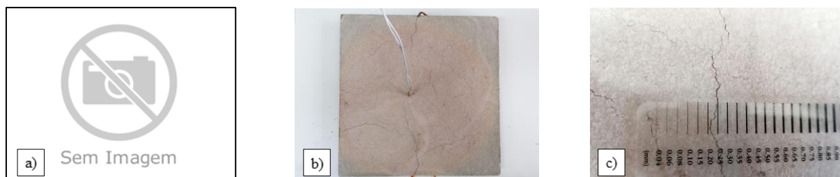
Figura A.23 – Provete P_A5_3_LA: a) Provete antes do ensaio; b) Provete após o ensaio; c) Fissuração do provete após o ensaio.
