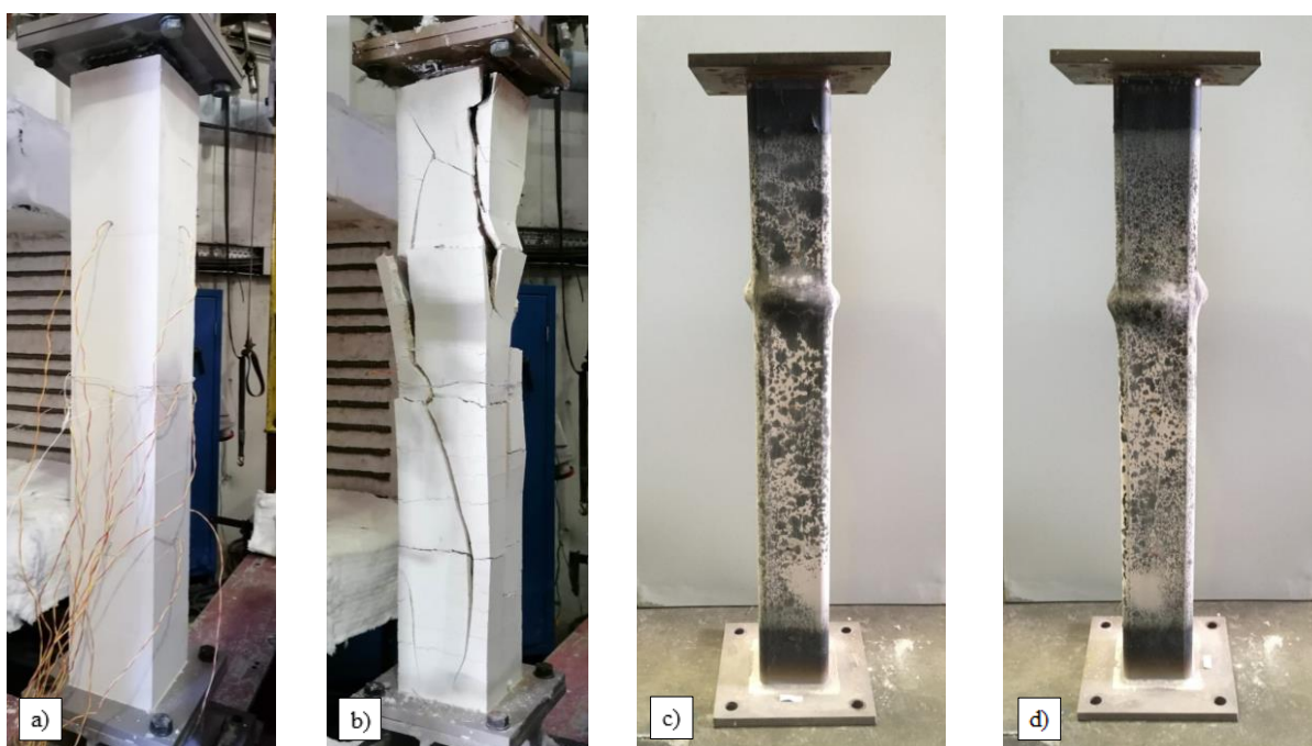
Figura B.3 – Provete PC_A1: a) Provete antes do ensaio; b) Destacamento da argamassa após o ensaio; c) Provete após o ensaio (direção 1); d) Provete após o ensaio (direção 2).
