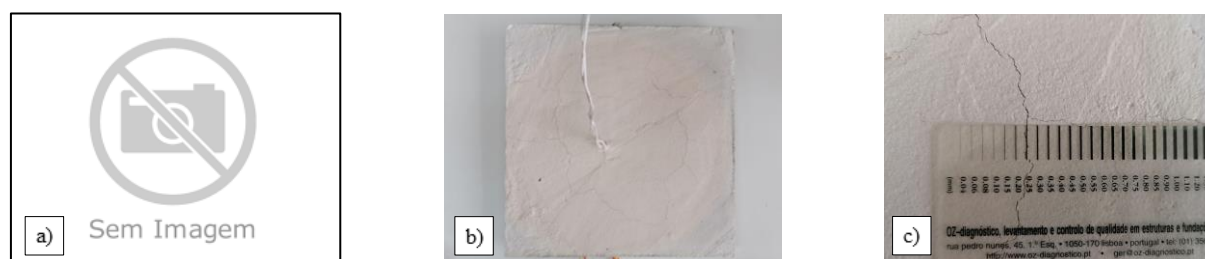
Figura A.11 – Provete P_A3_2_LA: a) Provete antes do ensaio; b) Provete após o ensaio; c) Fissuração do provete após o ensaio.
