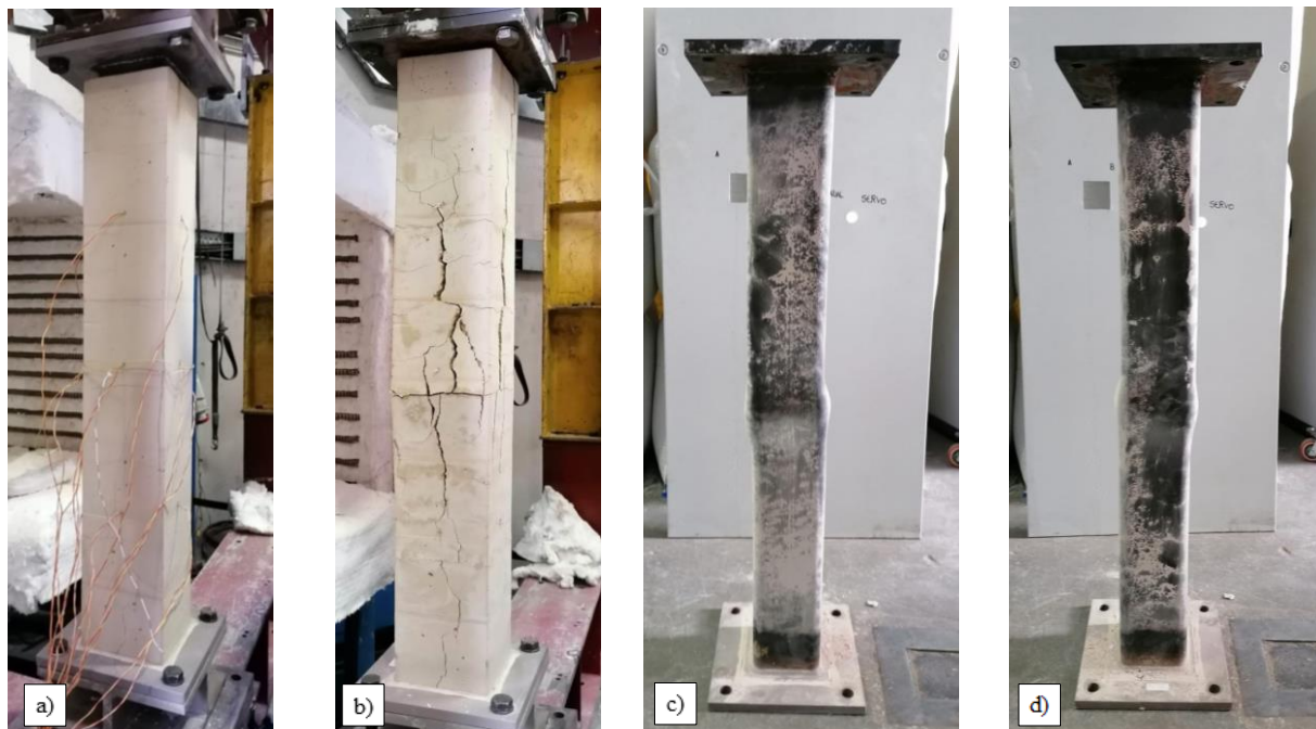
Figura B.4 – Provete PC_A2: a) Provete antes do ensaio; b) Destacamento da argamassa após o ensaio; c) Provete após o ensaio (direção 1); d) Provete após o ensaio (direção 2).
