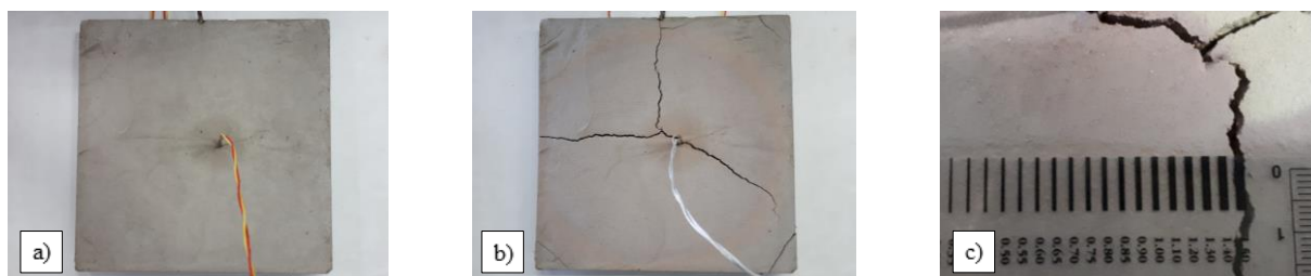
Figura A.26 – Provete P_A5_3_MI: a) Provete antes do ensaio; b) Provete após o ensaio; c) Fissuração do provete após o ensaio.
