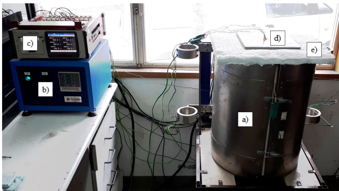
Figura 3.8 – Sistema experimental: a) Forno cilíndrico; b) Controlador do forno; c) Datalogger TDS-530; d) Provete de ensaio; e) Manta de lã cerâmica.
