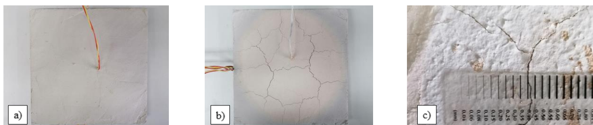
Figura A.19 – Provete P_A4_2_MI: a) Provete antes do ensaio; b) Provete após o ensaio; c) Fissuração do provete após o ensaio.
