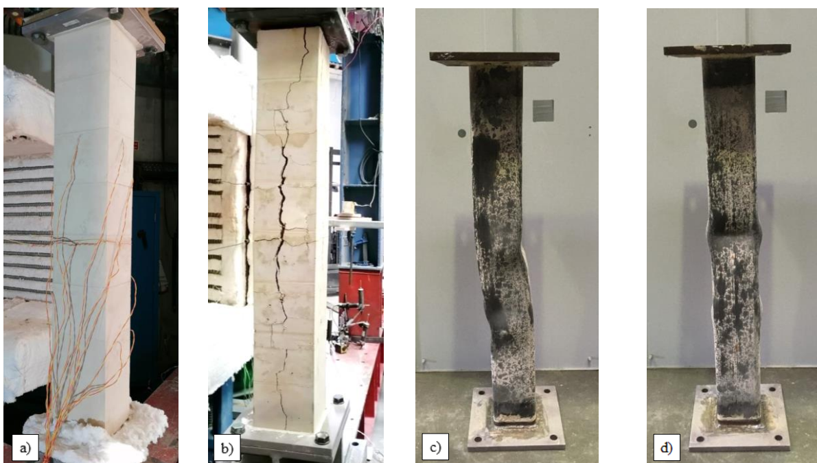
Figura B.5 – Provete PC_A4: a) Provete antes do ensaio; b) Destacamento da argamassa após o ensaio; c) Provete após o ensaio (direção 1); d) Provete após o ensaio (direção 2).
