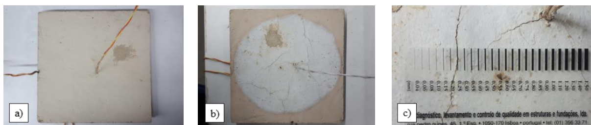
Figura A.6 – Provete P_A2_3_LA: a) Provete antes do ensaio; b) Provete após o ensaio; c) Fissuração do provete após o ensaio.
