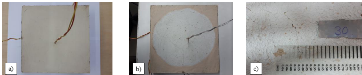
Figura A.5 – Provete P_A2_2_LA: a) Provete antes do ensaio; b) Provete após o ensaio; c) Fissuração do provete após o ensaio.
