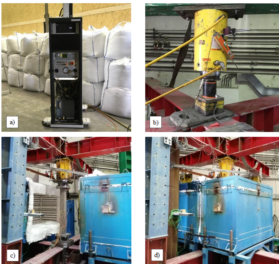
Figura 4.10 – Imagens de pormenor: a) Central servo-controlada; b) Macaco hidráulico e célula de carga; c) Forno aberto com provete para ensaio; d) Forno fechado e ensaio em curso.
