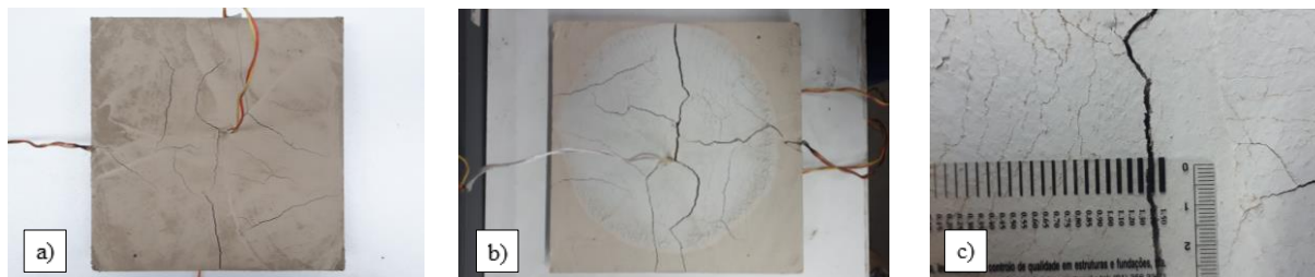
Figura A.9 – Provete P_A2_3_MI: a) Provete antes do ensaio; b) Provete após o ensaio; c) Fissuração do provete após o ensaio.
