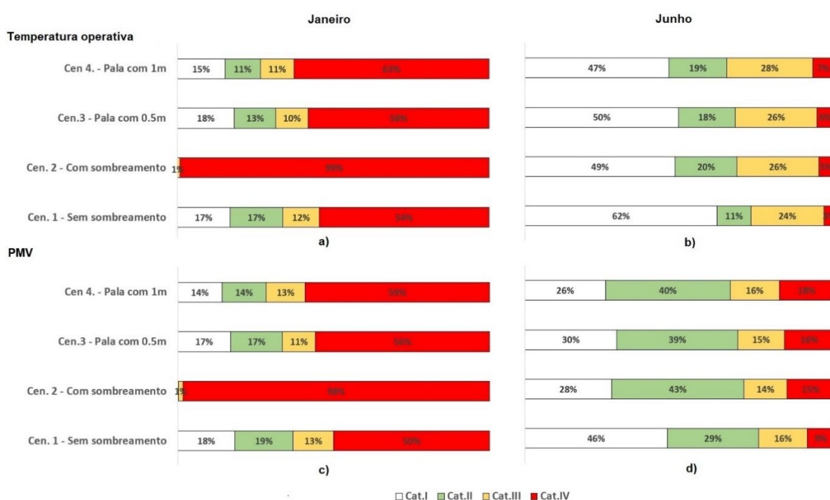
Figura 4.6. Temperatura operativa em: a) janeiro; b) junho e índice PMV em: c) janeiro; d) junho.
