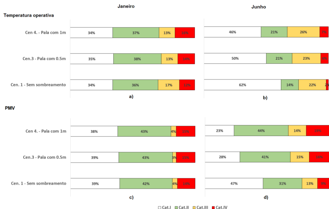
Figura 4.8. Temperatura operativa em: a) janeiro; b) junho e índice PMV em: c) janeiro; d) junho, com as novas temperaturas de funcionamento no sistema de climatização.
