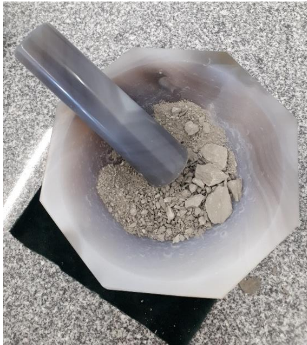
Figura III.7. Moagem da amostra para grão fino no almofariz de ágata.
