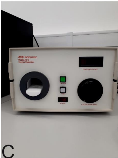
Figura III.10. A. Desmagnetizador- Molspin ; B. Magnetómetro- Molspin ; C. Magnetizador- ASC Scientific .
