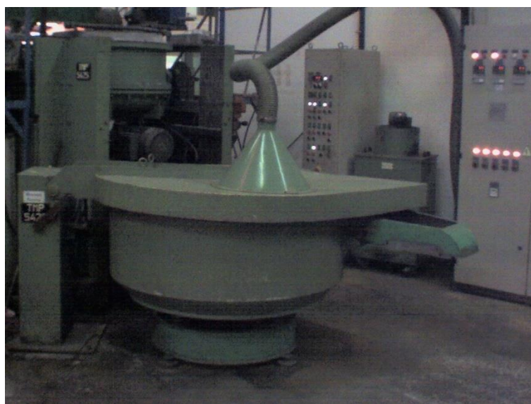
Figura 2.3 - Sistema de lavagem e secagem da zona da BARIAGEM (SRAMPORT, 2010)
