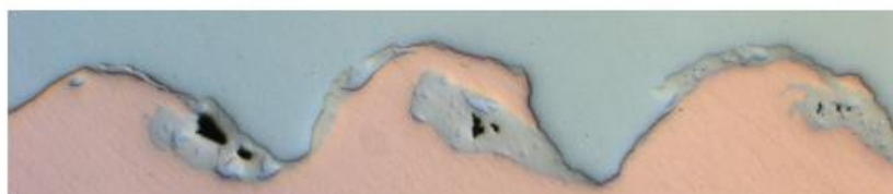
Figura 2.16. Micrografia num plano longitudinal da interface Cu-SS, adaptada de [35]
