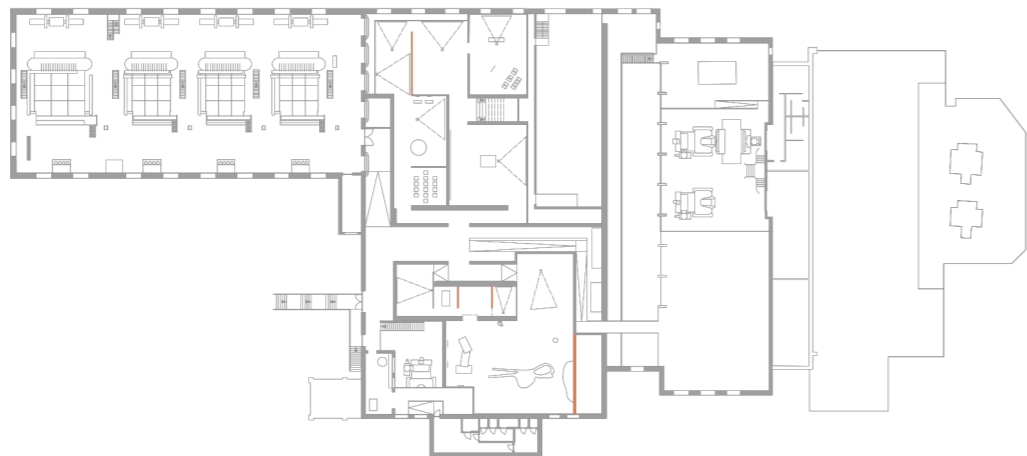
Fig. 138: Identificação das paredes incorporadas durante a fase de análise 3 Fonte: planta desenhada pela autora com base no material cedido por cortesia da Fundação EDP
