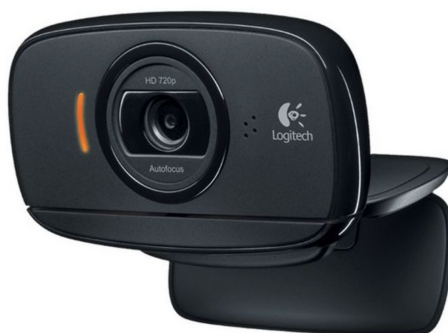
Figura 4.17: Imagem da webcam Logitech HD Webcam C525 usada para detetar a posição do objeto.
