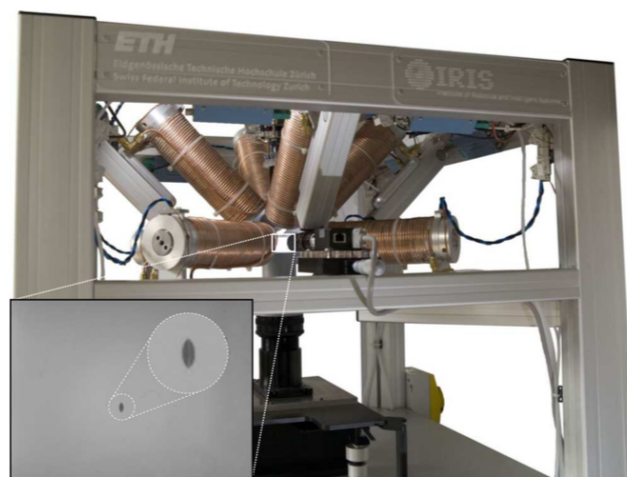
Figura 2.12: Sistema desenvolvido para controlo de posição e orientação [16].
