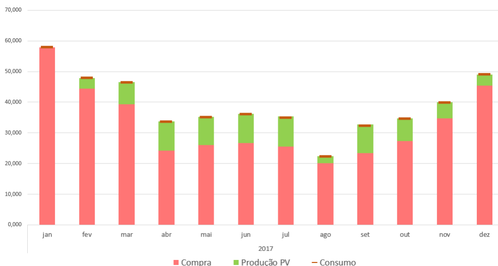
Figura H.1: Gráfico dos valores mensais do primeiro diagnóstico em 2017 (em MWh)
