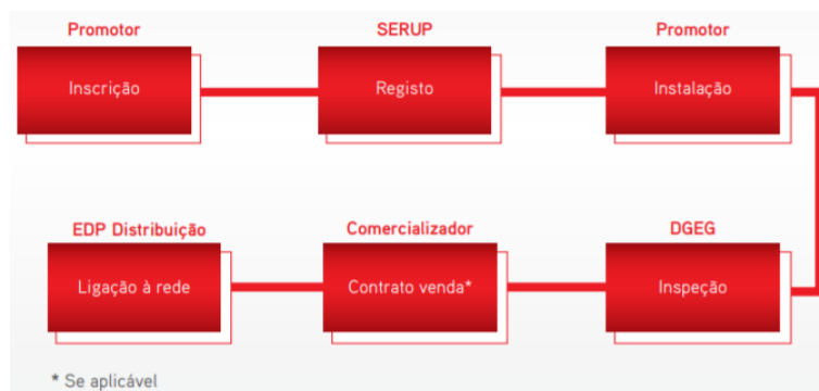
Figura 2.5: Esquema do processo de ligação da UPAC à RESP [24]
