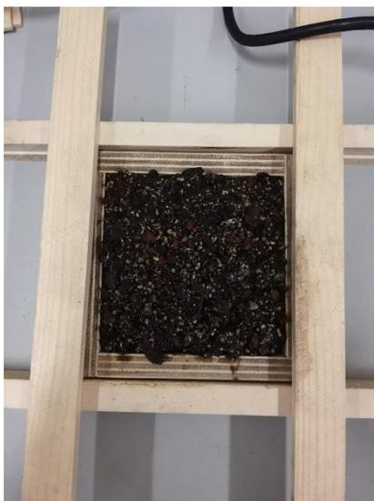
**Figura 18:** Amostra saturada e acomodada no provete para a realização do ensaio.
