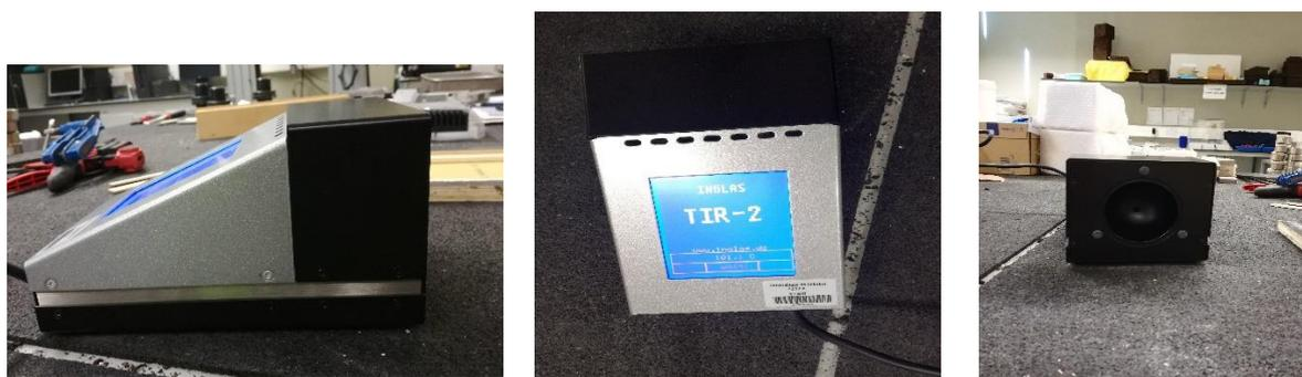
**Figura 15:** Aparelho TIR, usado na determinação das emissividades.
