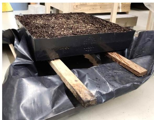
**Figura 24:** Saturação e escoamento da amostra antes de dar início ao ensaio.
