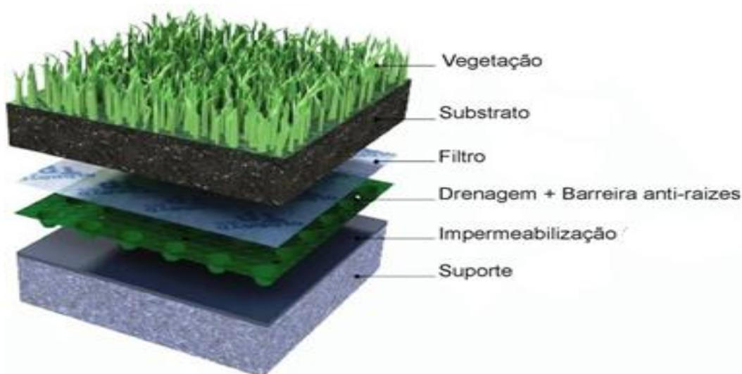
**Figura 3:** Componentes de uma cobertura verde. (Fonte: Stahlhöfer & Pereira, 2013).
