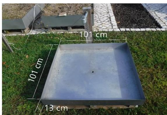
**Figura 21:** Tabuleiro utilizado durante o ensaio e suas dimensões.
