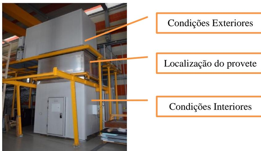
**Figura 27:** Câmara Bioclimática.
