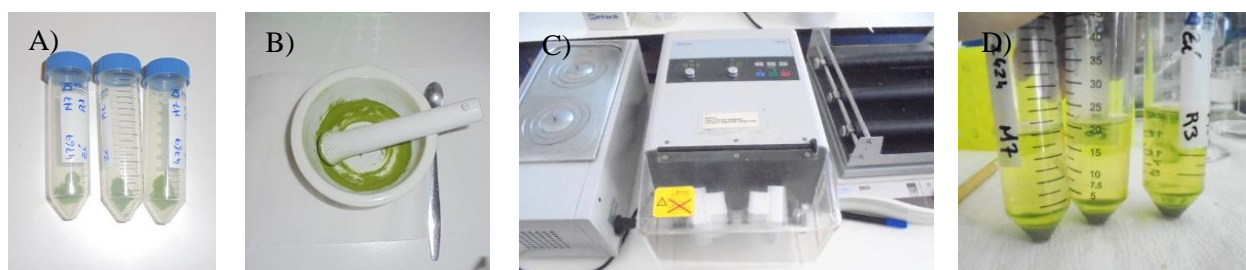
Figura 6 – Processo de extração para obtenção de extratos. A) Biomassa liofilizada; B) Maceração da biomassa com almofariz e pilão em azoto líquido; C) Extração em moinho de esferas; D) Extrato final.
