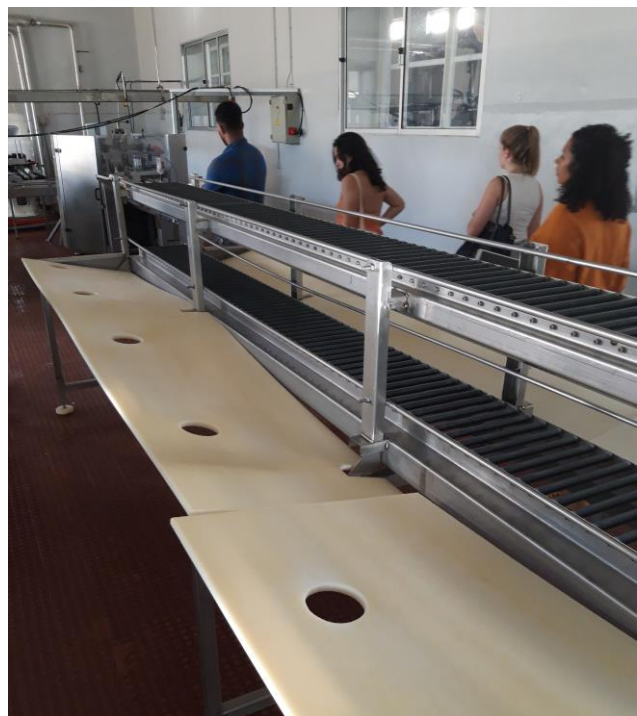
Figura 34 - Espaço interior da SUCLA, destacando equipamentos em aço inoxidável, pavimentos e revestimentos de parede em azulejo ou tijoleira para fácil limpeza. (2018)
