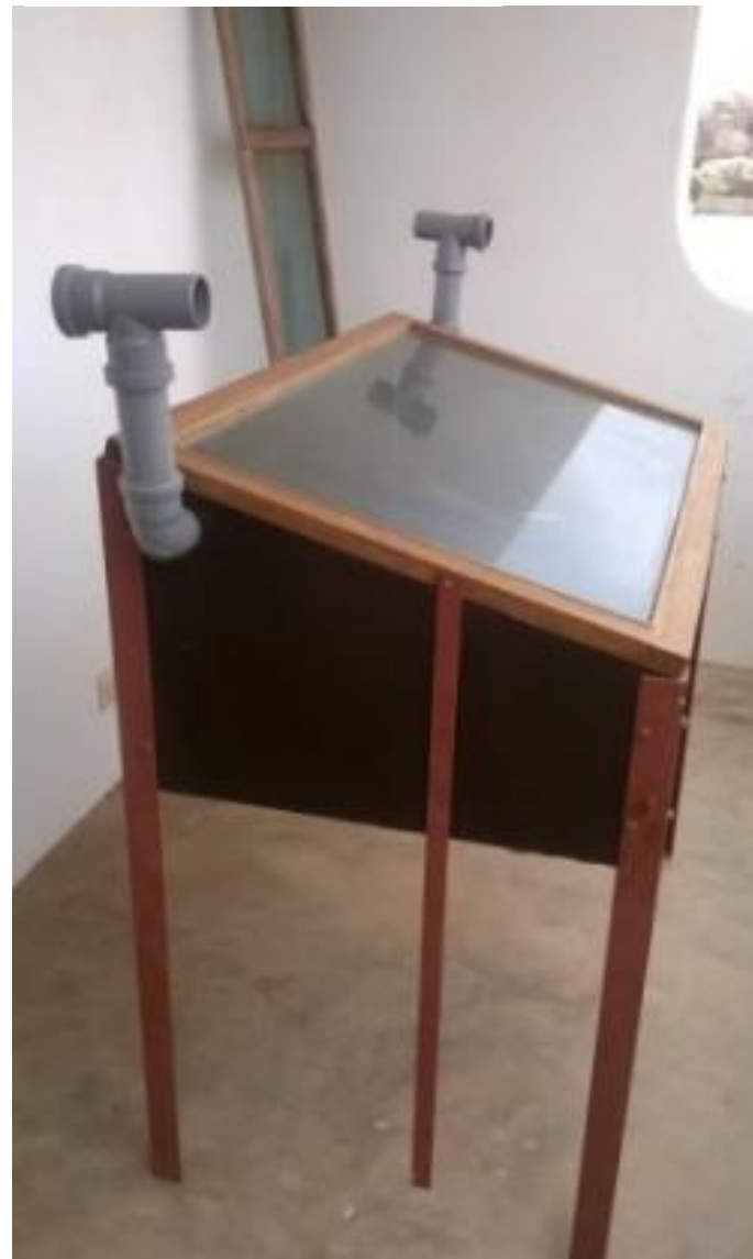
Figura 20 – Estufa solar de pequena dimensão (utiliza duas chaminés para ventilar o ar quente que auxilia a secagem do alimento) (A. Barbosa, 2015)
