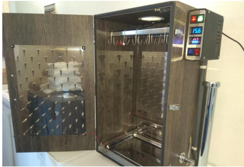
Figura 73 – Fumeiro mecânico industrial. Utiliza energia elétrica para funcionar, permite um controlo de variáveis térmicas superior à alternativa tradicional, maximizando uso e qualidade de produto. (Longer, 2010)
