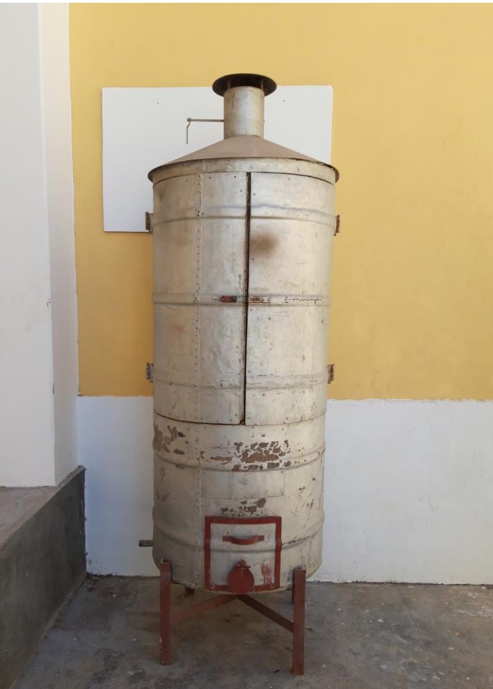
Figura 72 – Fumeiro tradicional cabo-verdiano. Utiliza combustíveis naturais, como lenha, para executar o processamento. (2019)
