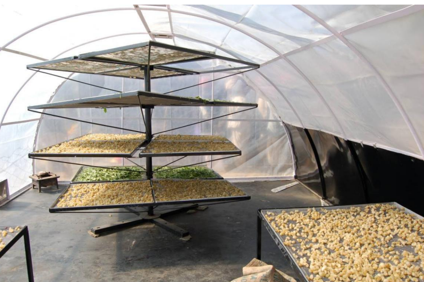
Figura 25 – Secagem em estufa com auxílio de tabuleiros permite um mais eficiente uso do espaço. (Joint Implementation Network, 2006)
