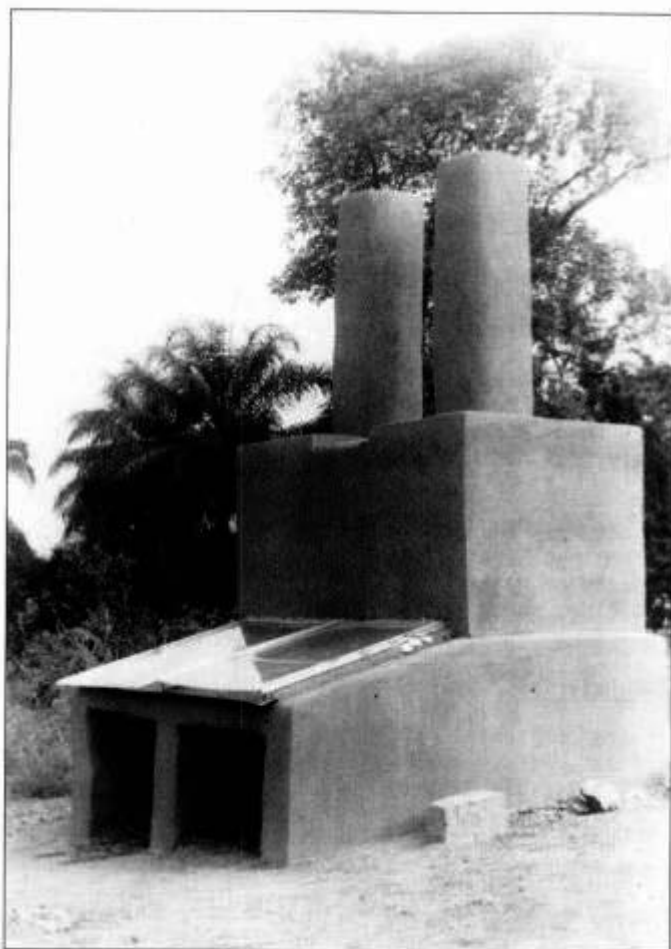
Figura 71 – Equipamento de secagem solar construído com adobe. As possibilidades de construção são muito versáteis e geralmente adaptadas ao local em que se realiza a atividade de secagem. (Bassey & Schimdt, 1986)
