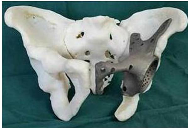
**Figura 5:** Prótese acetabular personalizada impressa em Ti6Al4V. Adaptado de Iqbal et al. 2017
