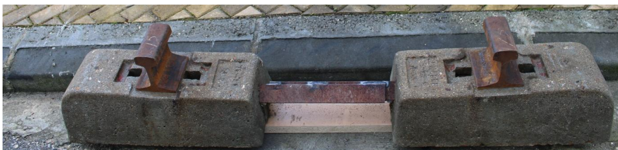
Figura A3.9 – Resultado final do processo de adaptação recorrendo-se à soldadura (por eléctrodo revestido básico) sobreposta.
