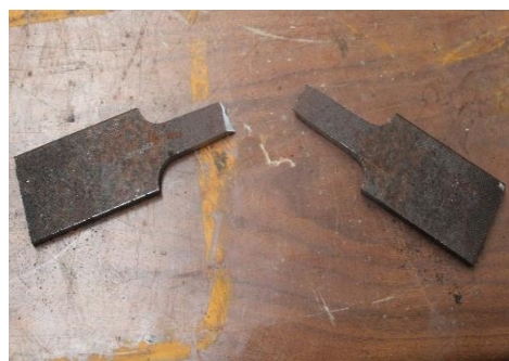
Figura A3.17 – Resultado do estado do provete após o ensaio de tração.
