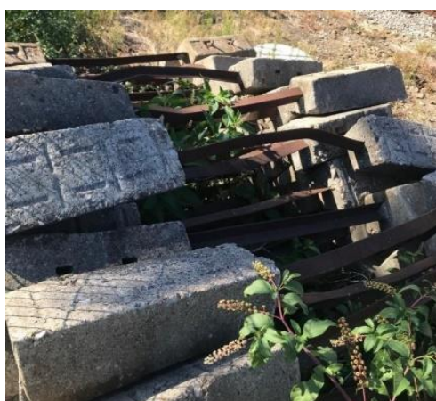
Figura A3.3 – Empeno das cantoneiras metálicas.
