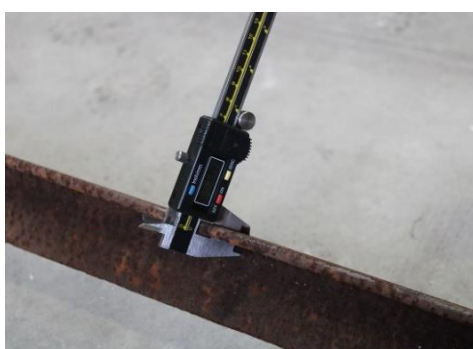
Figura A3.12 – Medição da espessura da cantoneira recorrendo-se a um paquímetro.
