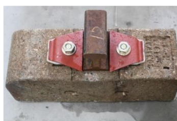
Figura 2.16 – Sistema de fixação Nabla - fixação elástica.
