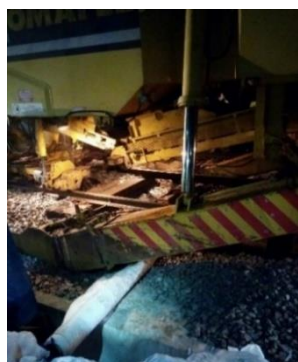
Figura A1.1 – Montagem da corrente da desguarnecedora.
