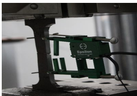
Figura A3.16 – Ensaio com extensómetro.
