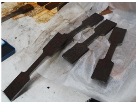
Figura A3.14 – Provetes maquinados e numerados.
