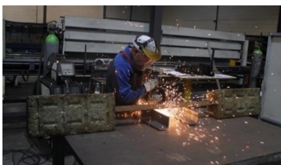
Figura 3.4 – Preparação, marcação e corte da cantoneira.
