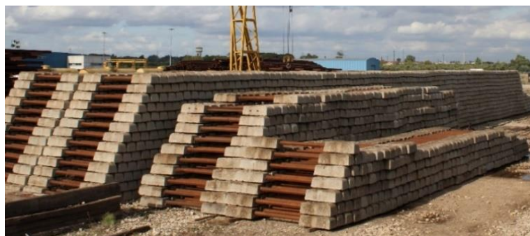
Figura 3.2 – Travessas bibloco existentes (10/2019) no Complexo Logístico do Entroncamento (CLE).
