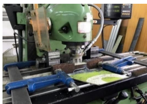
Figura A3.13 – Maquinação dos provetes recorrendo-se à fresadora universal.
