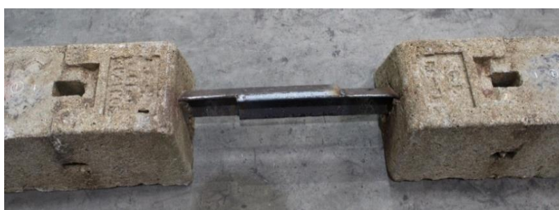
Figura 3.7 – Resultado final, obtido da adaptação da TBB (BB2) com bitola 1668 mm para bitola 1000 mm.
