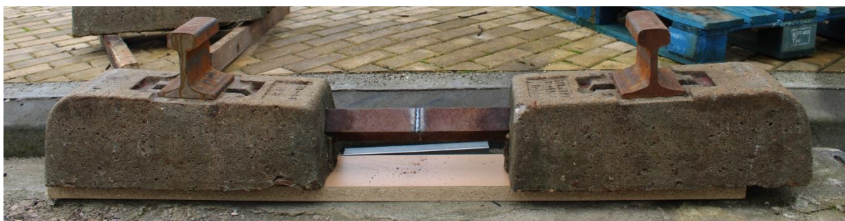
Figura A3.8 – Resultado final do processo de adaptação recorrendo-se à soldadura (por eléctrodo revestido básico) topo a topo.
