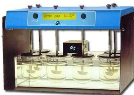
**Figura 12** – Aparelho de dissolução.
