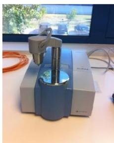
**Figura 6** – Equipamento FTIR.
