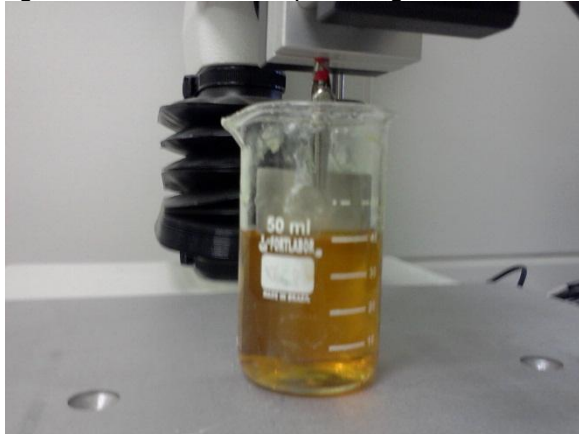
Figura 9 - Processo de dip-coating no texturômetro
