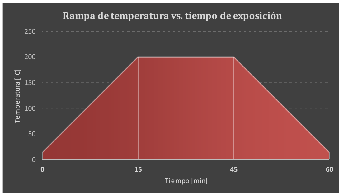
Figura 3-2: Rampa de temperatura vs. tiempo programada en el horno de corrosión cíclica.
