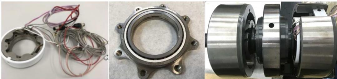
**Figura 3.9:** *Sleeve* (esquerda), rolamento (centro) e motor do *test rig* integrado com a *sleeve*, rolamento, sensores e respetivos cabos e conectores (direita). Crédito: consórcio iBearing [35].
