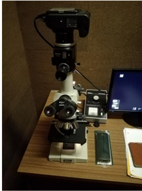
Fig. 2.2.1. - MO metalográfico da marca Nikon OPTIPHOT, acoplado com uma câmara fotográfica da marca Canon do Laboratório TAIL-UC.
