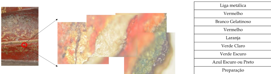
Fig. 3.2.1.2. – Amostra TRS_171: Local de recolha, montagem fotográfica das imagens por MO (com ampliação de 10X x 10X) e a estratigrafia observada da camada mais exterior (topo da estratigrafia) até à camada mais interior (fundo da estratigrafia).
