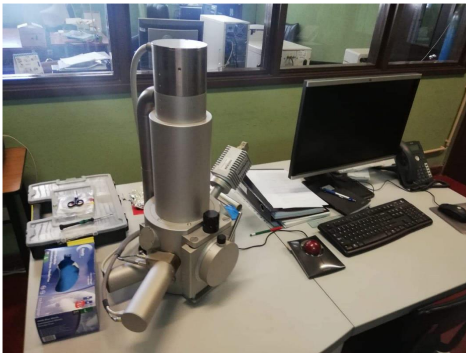
Fig. 2.5.4.1. - Aparelho de SEM TESCAN Vega3 SBH utilizado em amostras recolhidas dos túmulos e de elementos necessários para o estudo realizado de amostras previamente selecionadas, no Laboratório TAIL-UC.
