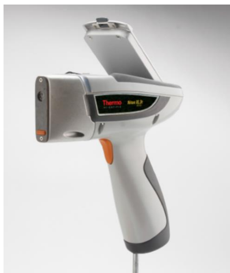
Fig. 2.3.5.1. – Aparelho de p-XRF Niton XL3t GOLDD+ XRF Analyzer utilizado nas análises in situ no Mosteiro de Santa Clara-a-Nova [62].
