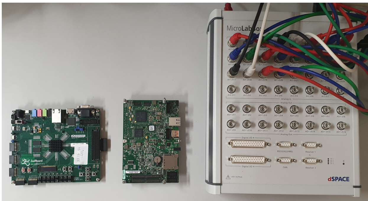
Figura E.3 Comparação de tamanhos entre ZedBoard, SB Rio e MicroLabBox .
