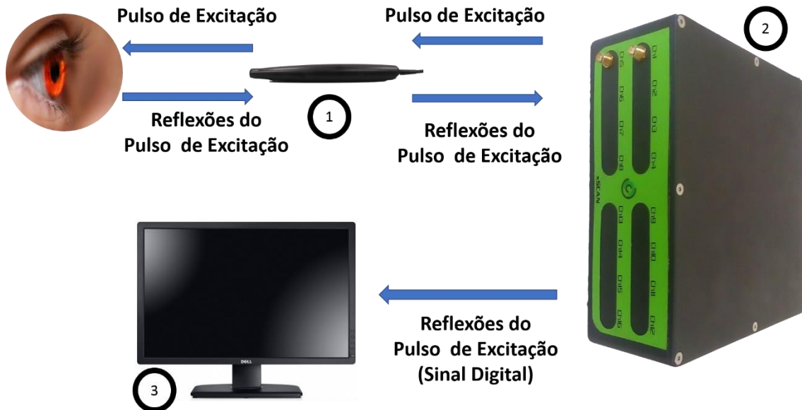
Figura 4.1 - Elementos que constituem o sistema de aquisição de sinais com o xSCAN
