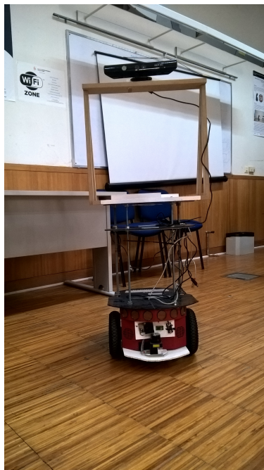
Figura 3.3: Robô pioneer 3dx equipado com um laser rangefinder Hokuyo - URG-04LX-UG01 e uma câmara kinect 360.
