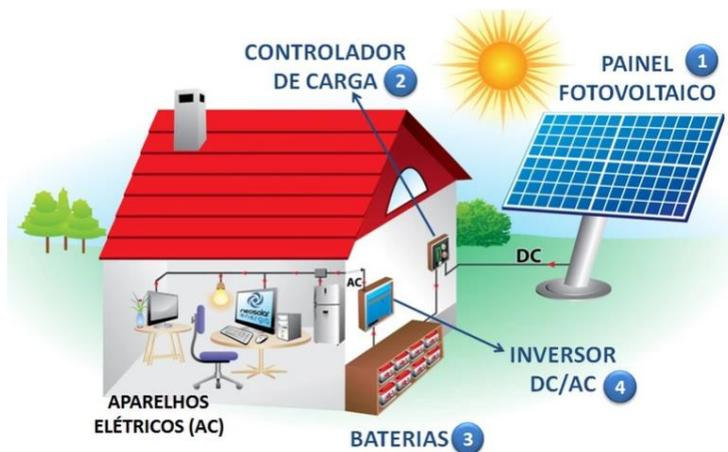
Fig. 2.1 – Sistema de autoconsumo isolado da RESP [15].
