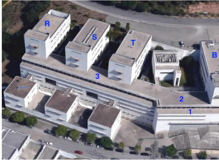
Figura 3.4: Divisão das áreas onde são colocados os painéis fotovoltaicos [33].
