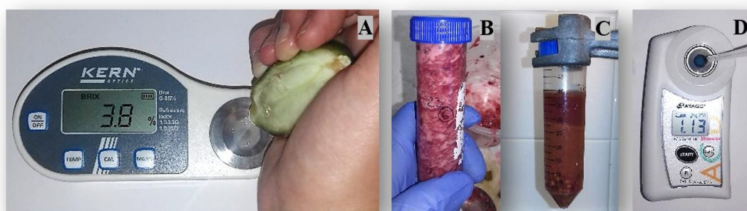
Figura 13 – Avaliação da qualidade dos frutos – Parâmetros físico-químicos. A) Medição do conteúdo de sólidos solúveis. B) Fruto processado (pré-centrifugação). C) Solução trifásica (pós-centrifugação). D) Medição da acidez.
