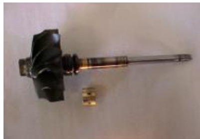
Figura. 2.26. Eje azulado, falta de lubricación.
