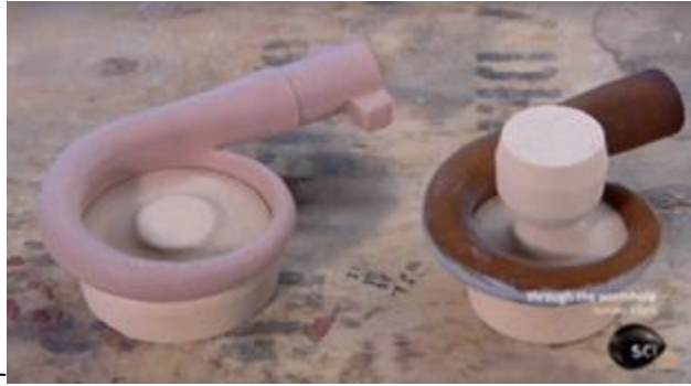
Figura 3.7. Corazón de arena para geometría interna de la carcasa compresora [42]
