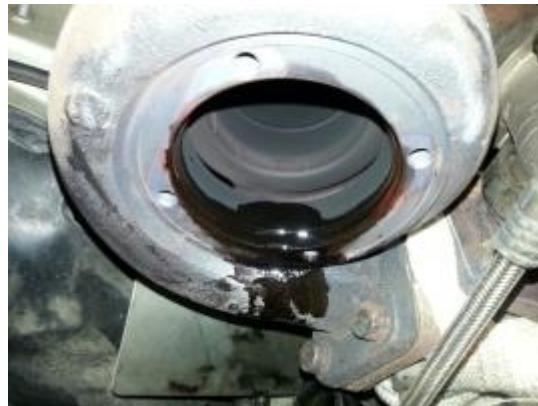
Figura 2.27. Fuga de aceite por la zona de compresión
