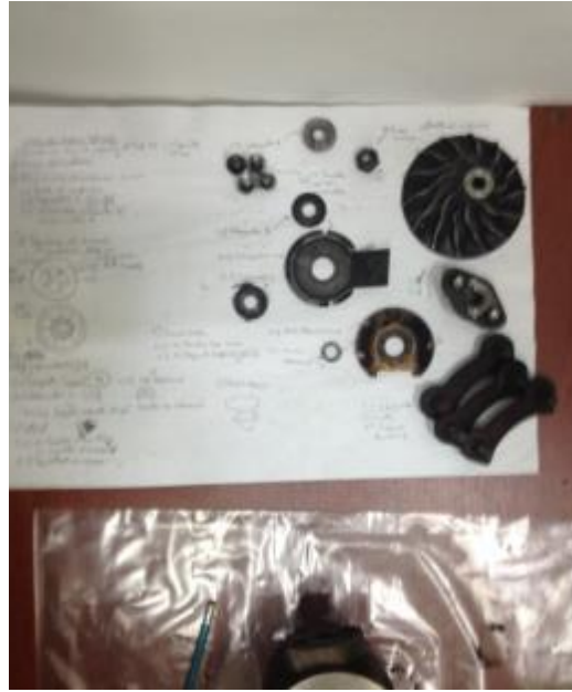
Figura 3.5. Ordenamiento de las piezas extraídas TKP-100 .
